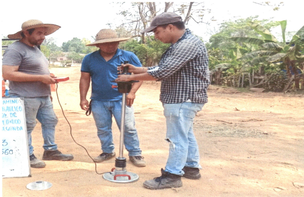
Figura 7 Determinación del grado de compactación con el LWD
