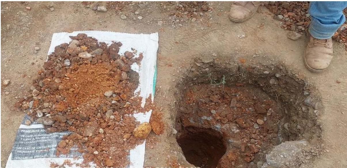
Figura 5.7.4. Pozo a Cielo Abierto PCA-02 carril único lado izquierdo
