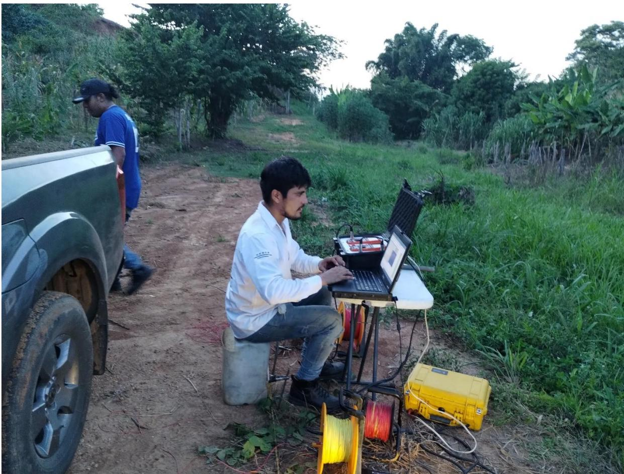
**Figura 6.** Equipo de resistividad utilizado para realizar el estudio geofísico de corriente directa (SEV).
