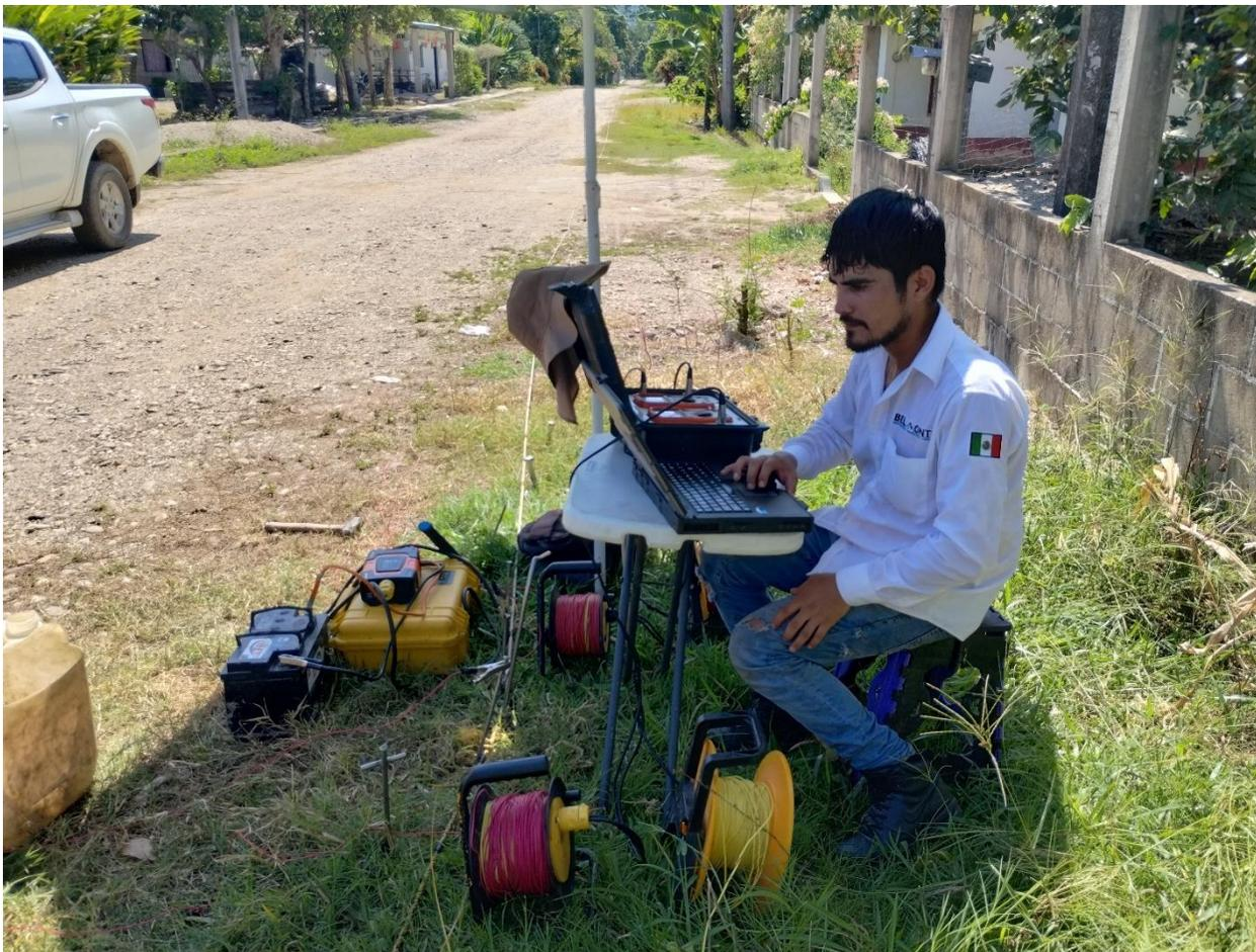
**Figura 6.** Equipo de resistividad utilizado para realizar el estudio geofísico de corriente directa (SEV).
