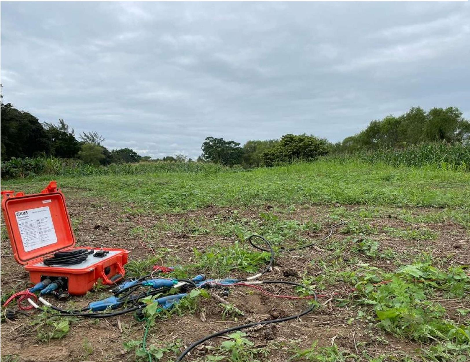
Evaluación geofísica mediante técnicas de sísmica pasiva para determinar la factibilidad de perforar un pozo exploratorio para la extracción de agua.
