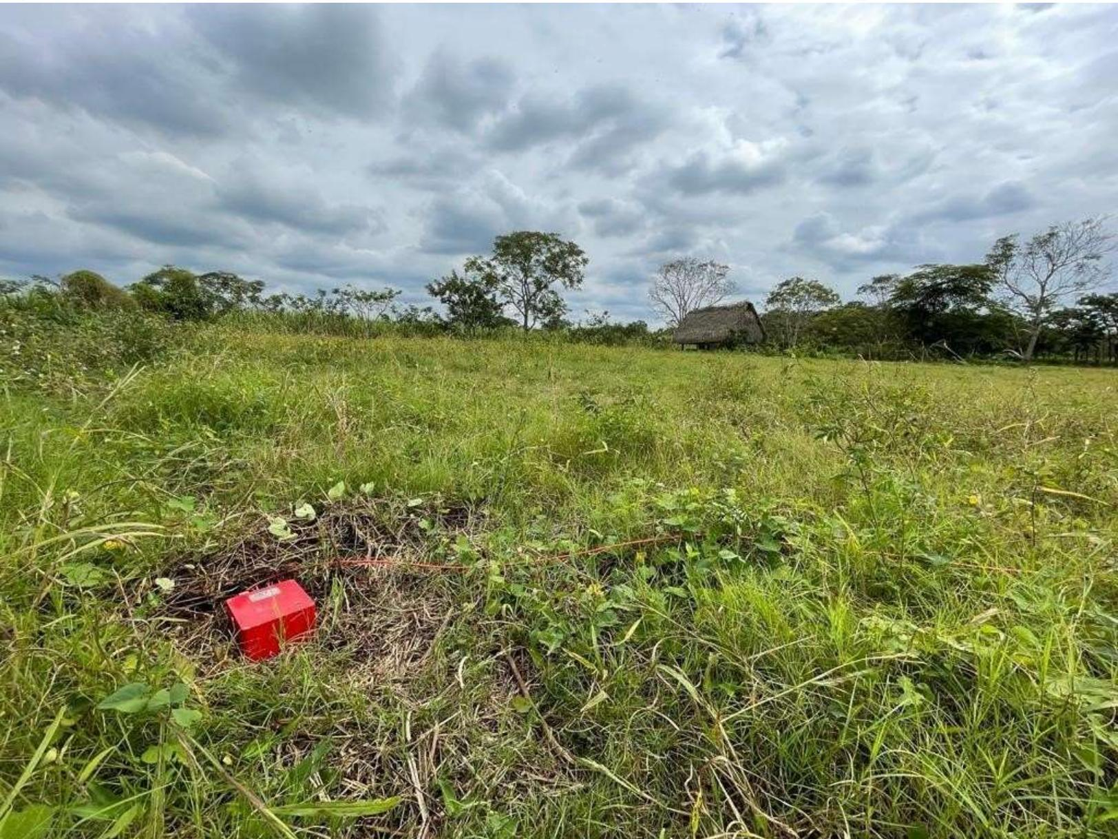
Evaluación geofísica mediante técnicas de sísmica pasiva para determinar la factibilidad de perforar un pozo exploratorio para la extracción de agua.
