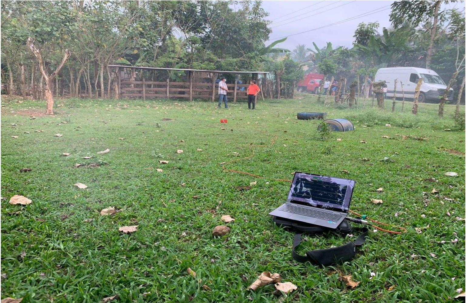
Evaluación geofísica mediante técnicas de sismica pasiva para determinar la factibilidad de perforar un pozo exploratorio para la extracción de agua.
